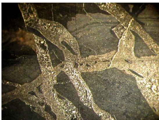
1 – сурет - Концентрлі-зоналық құрылымы бар жұқа түйіршікті псиломелан агрегатындағы пиролюзит (ақ) тамырлары, аншлиф 1, Чашма кен орны
